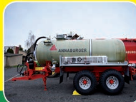
Cisterna Annaburger HTS 16.27 NOVA objem 12 m 3 , laminátová nádrž, vývěva, rozstřikovací talíř, pneu 550 Cena: 861 000,- Kč + DPH
