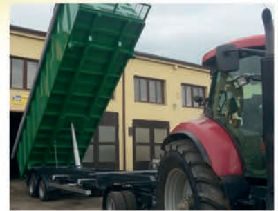
Traktorový přívěs - nosič kontejnerů. Nosič kontejnerů je s možností sklápění do boku. Kapacita a provedení je řešena na přání jako zakázková výroba. Celková hmotnost od 1,5 tuny až 32 tun s možností až čtyř náprav.
