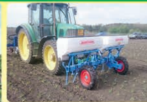
Přihnojovače, aplikátory mikrogranulí, pokladače kapkové závlahy a jiné spec. příslušenství
