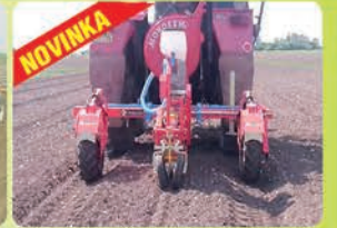
Přesné podtlakové seti dýní, cuket atd. - možnost výsevu do fólie, pokládání fólie i kapkové závlahy
