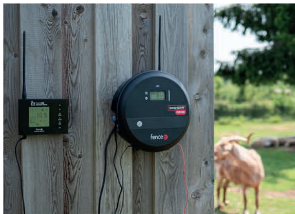
Centrální gateway s generátorem EDX
