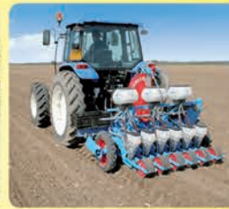
Speciální sečí stroje pro výsev malých semen Monosem MS
