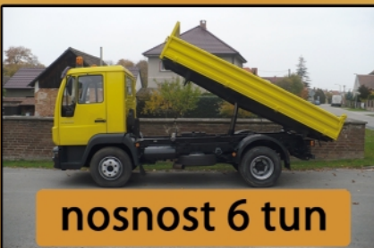
MAN 10.220 SKLÁPĚČ Meiller 10/2003, 243tkm, třístranná sklopka Meiller, 6 válec, nosnost 6 tun, uzávěrka, nez. topení, čep 40mm + koule 50mm, velmi dobré pneu a brzdy, kotoučkový tacho, celkově velmi dobrý stav, cena 485 000,- + DPH
