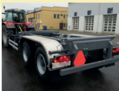
Traktorový tandemový návěs dvouosý Nosič výměnných zemědělských nástaveb s korbou a cisternou
