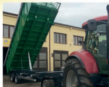
Traktorový přívěs - nosič kontejnerů. Nosič kontejnerů je s možností sklápění do boku. Kapacita a provedení je řešena na přání jako zakázková výroba. Celková hmotnost od 1,5 tuny až 32 tun s možností až čtyř náprav.
