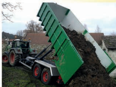
Nosič výměnných zemědělských nástaveb, jako přívěs za traktor.
