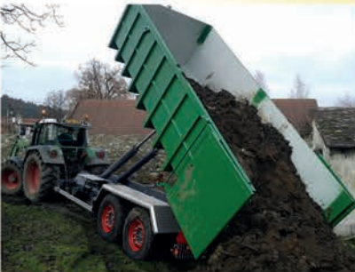
Nosič výměnných zemědělských nástaveb, jako přívěs za traktor.
