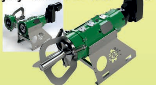
Šnekové separátory pro výrobu podestýlky - sušina až 40%
