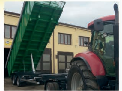
Traktorový přívěs - nosič kontejnerů. Nosič kontejnerů je s možností sklápění do boku. Kapacita a provedení je řešena na přání jako zakázková výroba. Celková hmotnost od 1,5 tuny až 32 tun s možností až čtyř náprav. Cena dohodou
