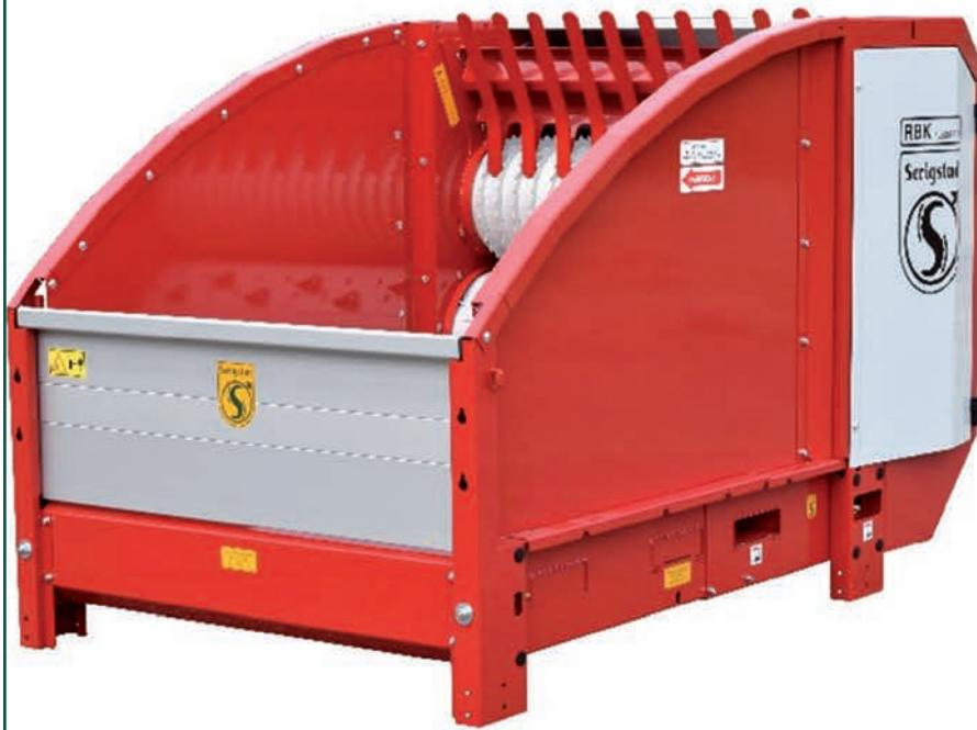
Standardní model rozdružovače **FlexiFeeder** je osazen 20 dvojitými noži zajišťujících efektivní řezání a vysokou kapacitu stroje při regulovatelných otáčkách do 380 ot./min.
