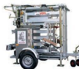
Kompaktní řešení klece pro snadný převoz a manipulaci, kterou lze snadno převážet po vlastní ose. Na místě je klec připravena k práci během 15 minut. Součástí je integrovaná naháňka, hydraulicky ovládané zvedání všech končetin a zdvih do pracovní výšky 60 cm. Napájení je volitelné na 220/400 V. Typ WOPA SA0051
