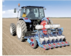
Speciální sečí stroje pro výsev malých semen Monosem MS
