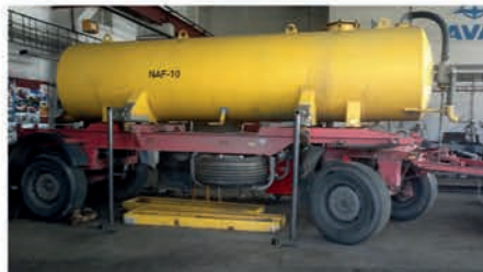
Přívěs automobilový Nosič výměnných zemědělských nástaveb
