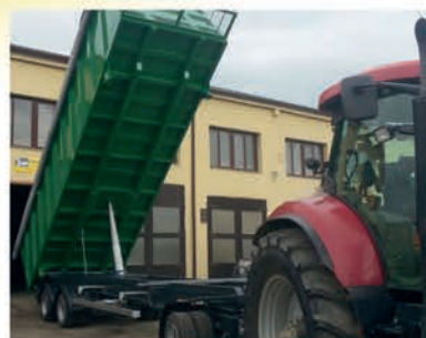
Traktorový přívěs - nosič kontejnerů. Nosič kontejnerů je s možností sklápění do boku. Kapacita a provedení je řešena na přání jako zakázková výroba. Celková hmotnost od 1,5 tuny až 32 tun s možností až čtyř náprav. Cena dohodou
