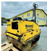
2011 válec 1t/75cm tandem Bomag BW75 H, diesel Yanmar
