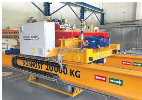
Zavázeční zařízení zdrojů ionizovaného záření
